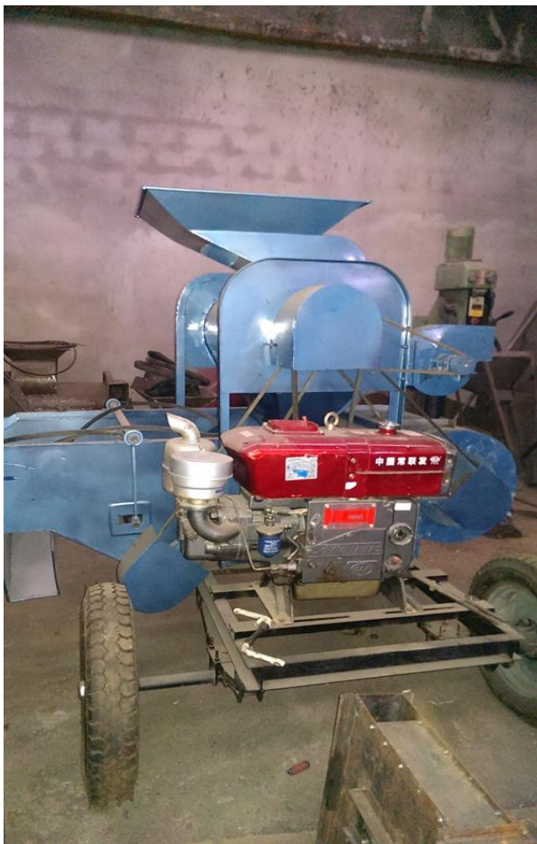
Abbildung 7: Einige Herstellungen von Godefroy Piam Fokam Links: Eine maisentkörnermaschine; Recht: Kaffeeschäl- und sortiermaschine (noch nicht fertiggestellt)
